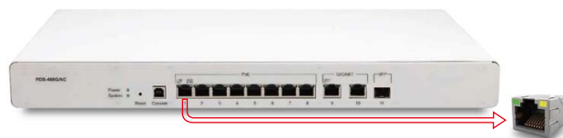
圖 (三) RJ45 埠帶 LED 顯示 PoE 狀態
