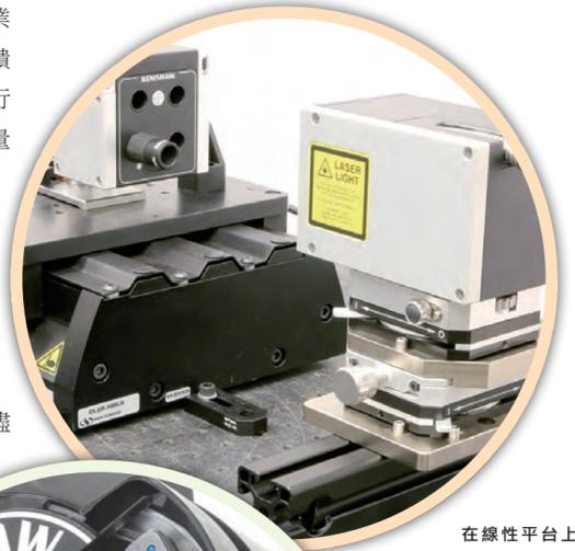
在線性平台上的 XM-60 多光束校正儀。 Renishaw
