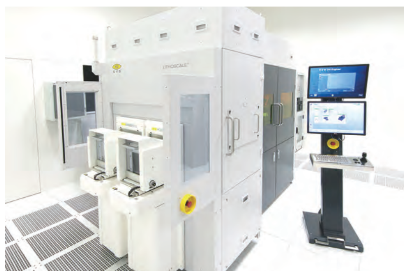
EV Group革命性的LITHOSCALE無光罩曝光系統滿足市場及應用對於高度靈活性或產品變化的微影需求。
