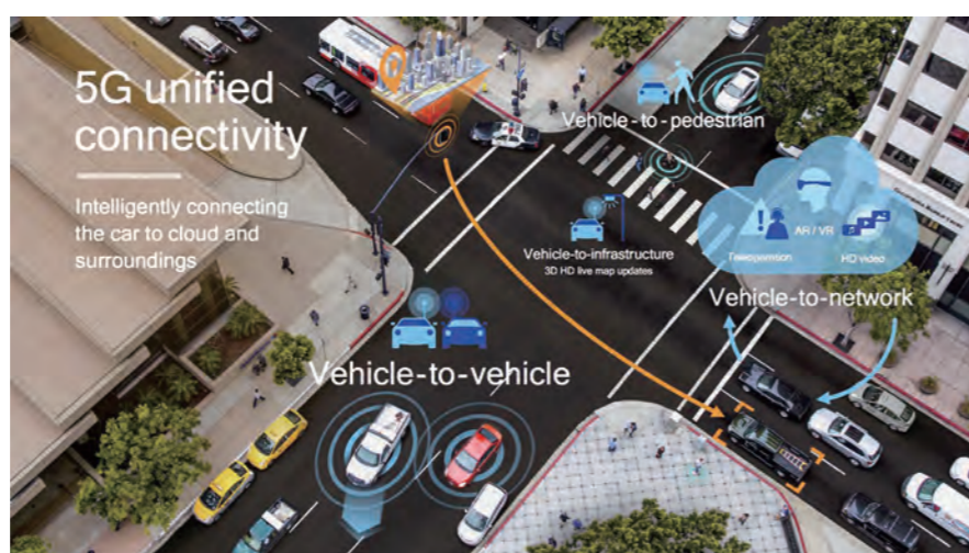
▲基於5G蜂巢式通訊技術的C-V2X技術方案，可在非視距環境下發揮遠端交通事故預警的提示作用。
